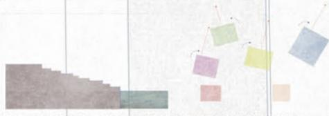
1. 既存の堤防を掘削し、街と川を緩やかに繋げる。掘削してできた地盤は蹴上の異なる大きな階段状とし、小さなスーパー堤防のような、強さを担保しながら、強く隔てられた境界を解体し柔かい居場所をつくる。
